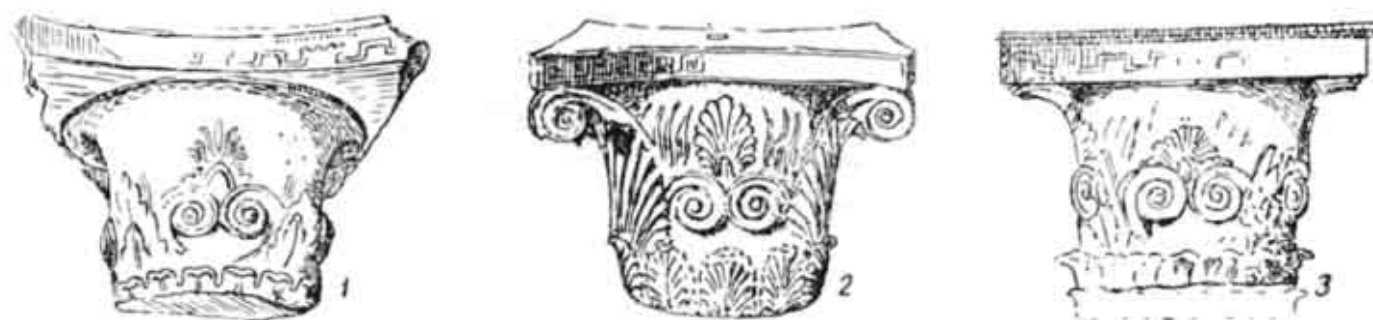
Храм Аполлона в Бассах. Коринфская капитель: 1. По Коккерелю; 2. По Штакельбергу; 3. По Коккерелю (вариант)
