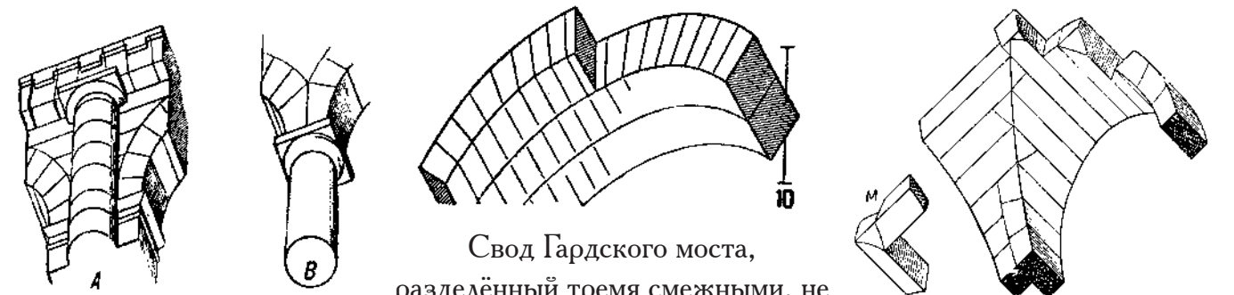
Древнеримская аркада: А — арка опирается на прямоугольные столбы и перекрыта антаблементом, архитрав которого служит разгрузочной аркой; В — арка, найденная в Помпеях: опорой является круглая колонна, как в Византийской архитектуре
