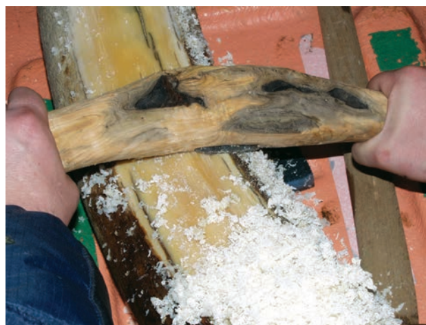
Рис. 126. Строгание бивня мамонта двуручным стругом
