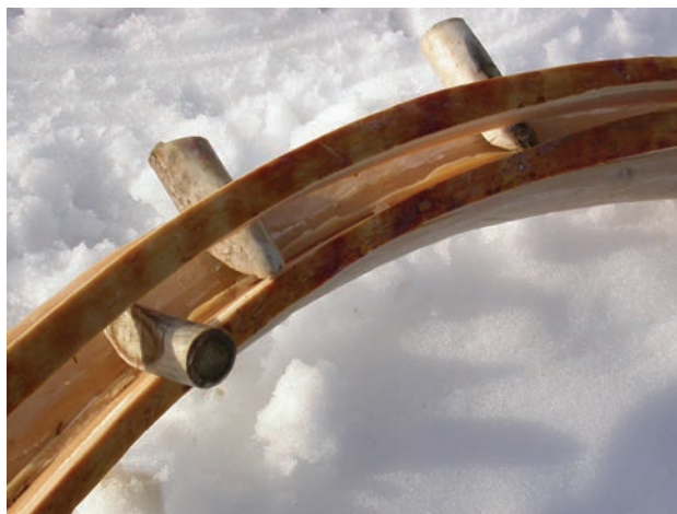
Рис. 99. Отделение стержня при помощи роговых клиньев
