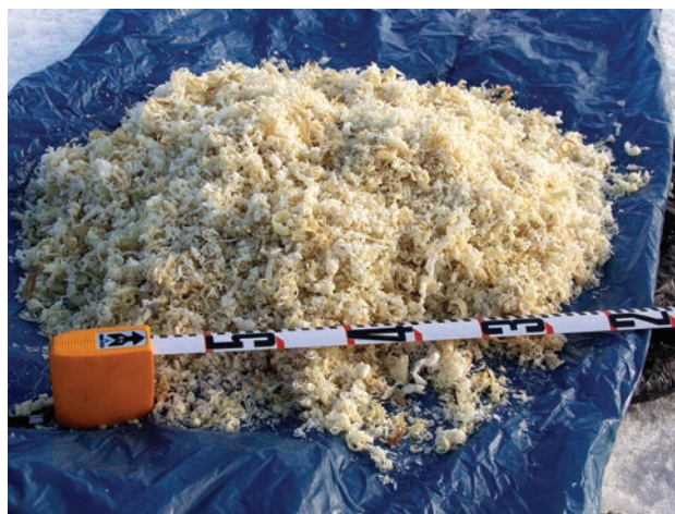
Рис. 129. Бивневая стружка, полученная в результате одного часа работы двуручным стругом
