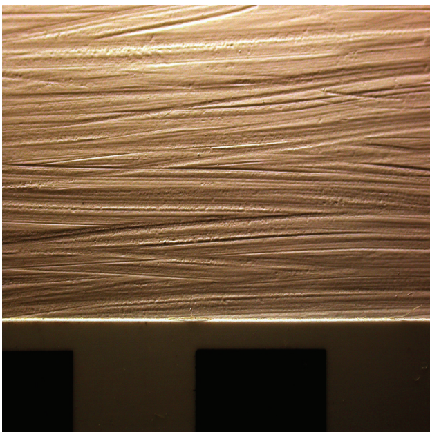
Рис. 130. Следы использования двуручного струга на бивне
