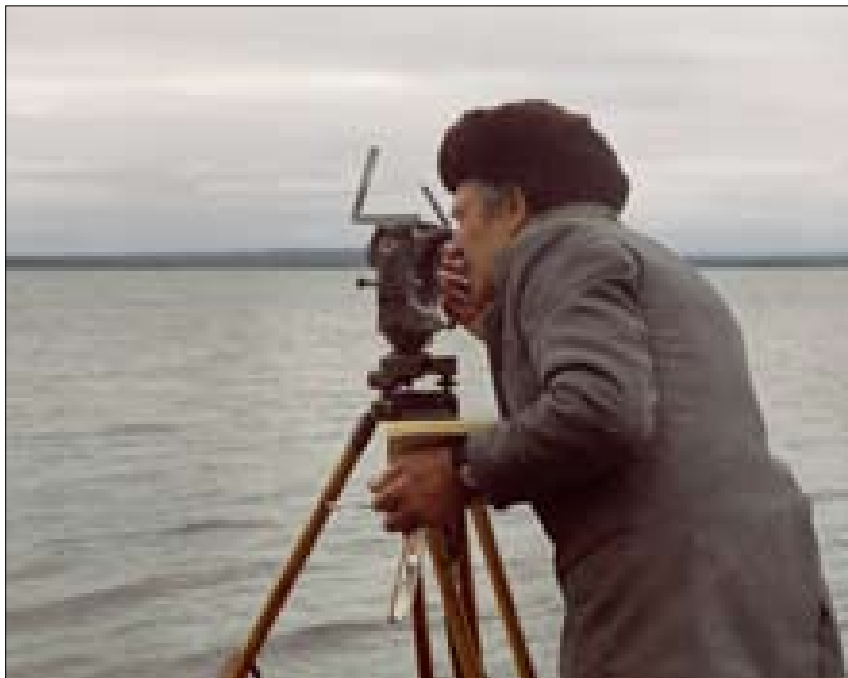
Топосъемка с помощью теодолита. Остров Еловый. 1998 г.
