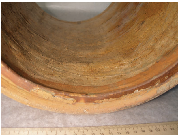
Рис. 5. Вид трубы № 8 внутри. Стенки неровные (техника спиральной лепки из жгутов с подправкой на гончарном круге), заглажены и покрыты тонким слоем бежевой поливы
