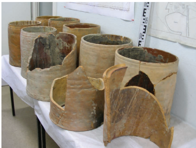
Рис. 4. Коллекция красноглиняных внутристенных труб калориферного отопления из Святительского корпуса. Трубы № 8–17. Экспресс-выставка в отделе археологических исследований Соловецкого музея-заповедника перед их сдачей в фонды. Ноябрь 2011 г.
