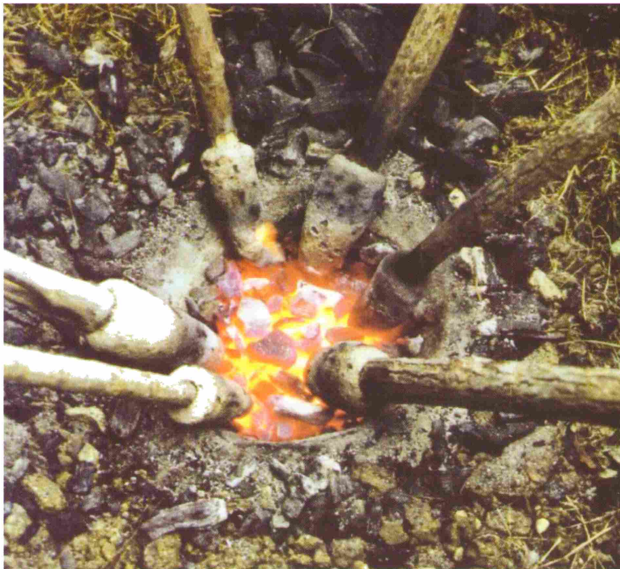
Рис. 8.3. Воздуходувные трубки из стволов бузины с глиняными накопечниками. Эксперименты швейцарских ученых по выплавке меди архаическим способом. Фото по работе [Fasnacht 1999, S. 293, Abb. 4]
