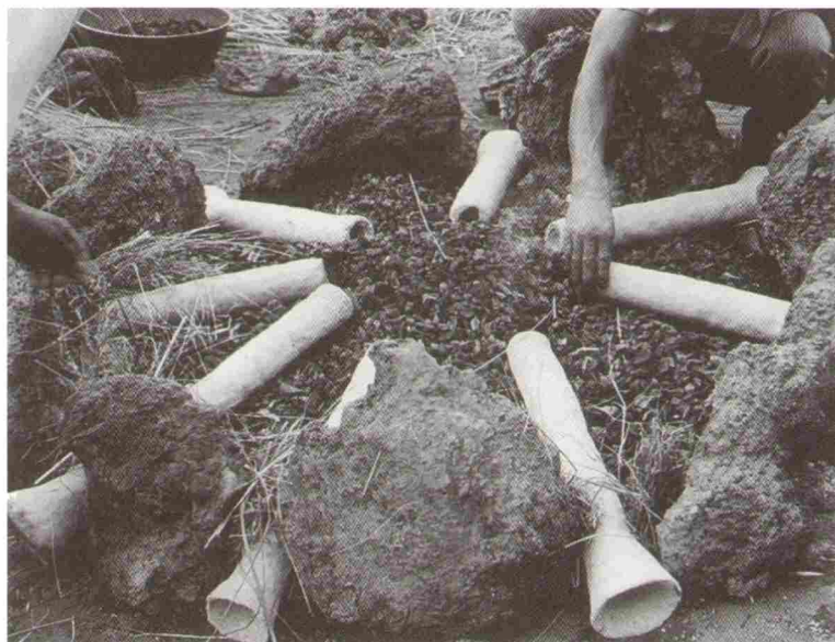
Рис. 8.1. Подготовка плавильной печи: укладка блока глиняных фурм перед началом выплавки металла (Восточная Африка). Фото по работе [Schmidt 1997, p. 80, fig. 4.5]
