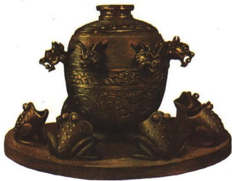
Древний китайский сейсмограф, приспособление для регистрации землетрясений.
