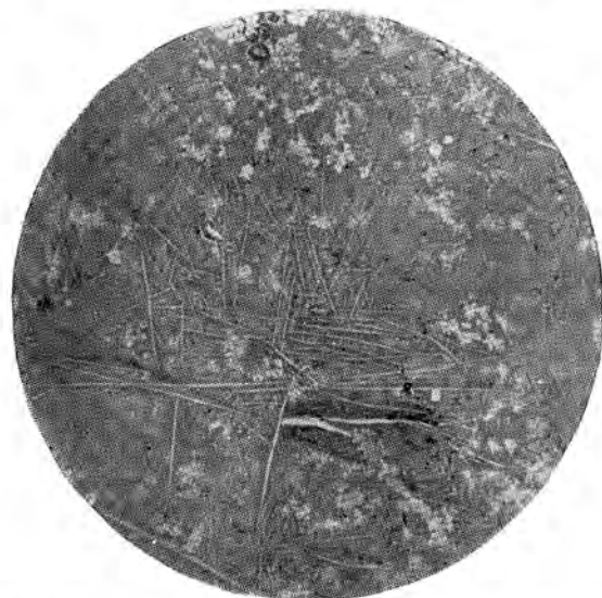
Рис. 3. Сrostки мельчайших капелек куприта и иголочки халькотрихита в шлаковой массе. Обр. № 18, \times 90 .
