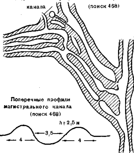
Распределительное устройство магистрального канала (поиск 468)
