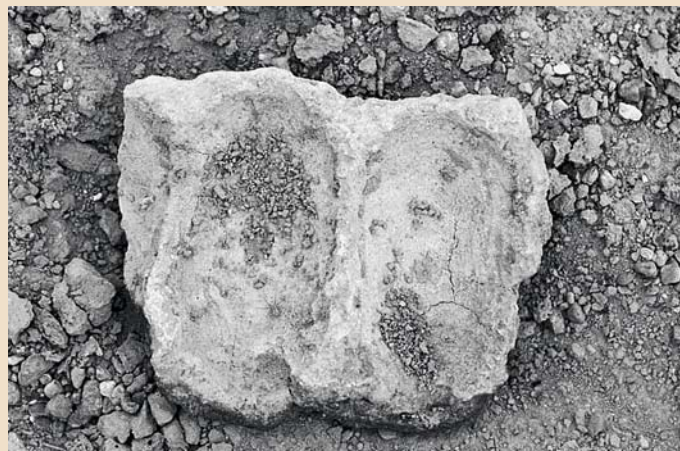
Ил. 8. Фрагменты свинцового глета из Арисмана, Иран. В углублениях после купелляции могло остаться серебро
