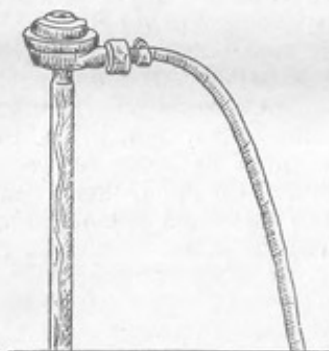
Рис. 9. Дождевальная насадка Гела со шлангом, закрепленная на деревянной рейке в качестве стойки.
