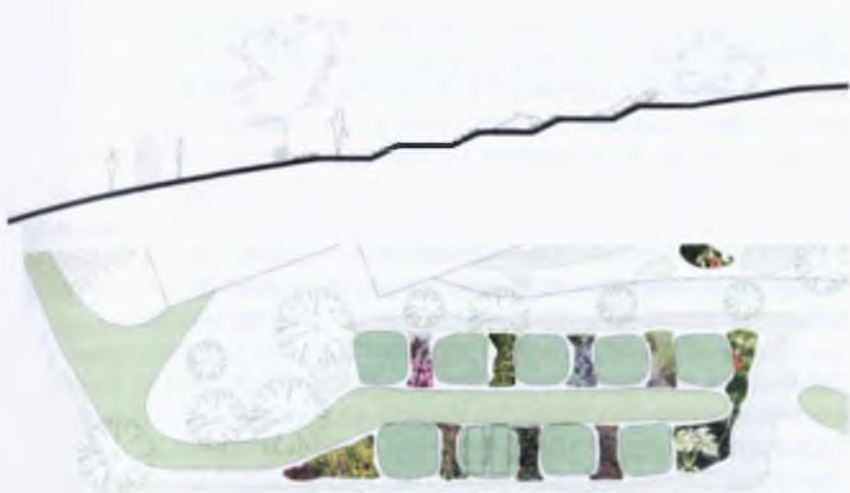
Травяное сооружение для сада Спа отеля Штайрер Хоф ***** в Бад Вальтерсдорфе: площадки с лежанками и травяными подушками (внизу горизонтальная проекция, вверху разрез). Концепция: семья Хольцер, плановое изображение — Йенс Калькхоф 2009 г.
