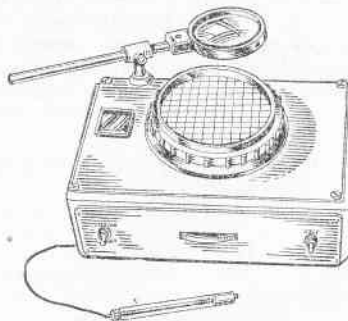
Рис. 12. Прибор ПСБ для подсчета колоний бактерий.
