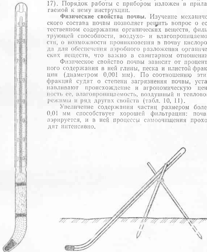
Рис. 16. Почвенный термометр Саввинова. Принцип измерения температуры почвы.
