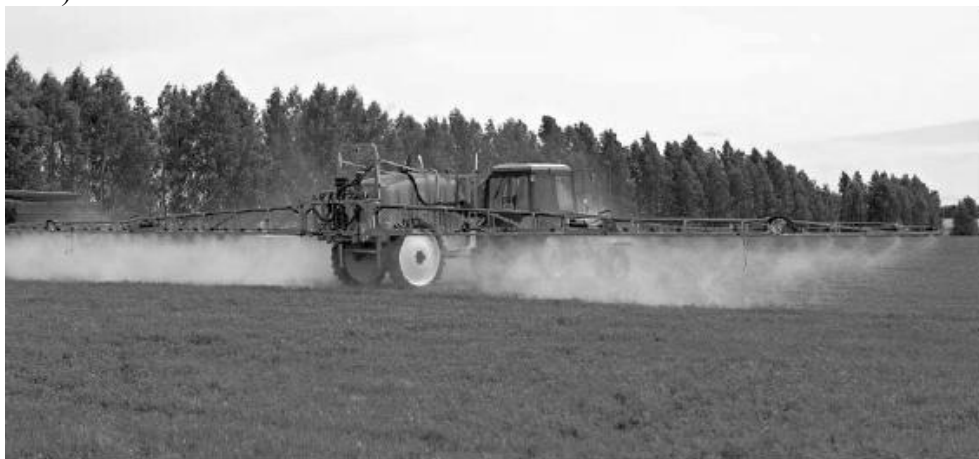
Рис. 33. Высота штанги над обрабатываемой поверхностью почвы более 1 м
