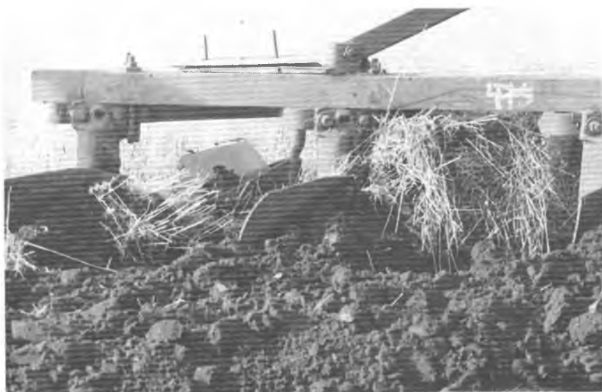
Фото 3. Плуг ПН-4-35 в работе (круглый нож забился соломой)
