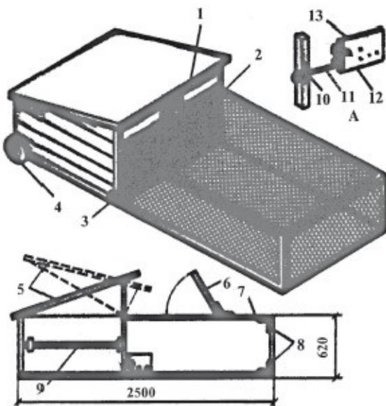
*Передвижной птичник: 1 — вентиляционная решетка; 2 — застекленная фрамуга; 3 — шомпол для открывания дверки; 4 — колесо; 5 — крышка подъемная; 6 — люк клетки; 7 — деревянные бруски сечением 40х70 мм; 8 — металлические уголки; 9 — насест; 10 — скоба крепления шомполя; 11 — шомпол с петлей; 12 — кронштейн; 13 — дверка; А — механизм для управления дверкой*
