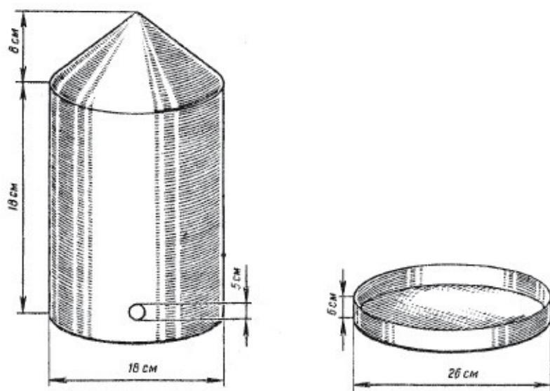
Автоматическая поилка из оцинкованного железа
