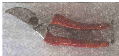
Обводной секатор с нерегулируемой шириной захвата ручек
