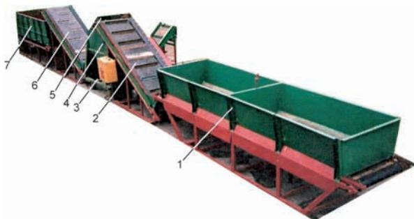
Рис. 2. Общий вид комплекса технических средств механизации приготовления субстратов и их расфасовки для малообъемной технологии в овощных теплицах:
