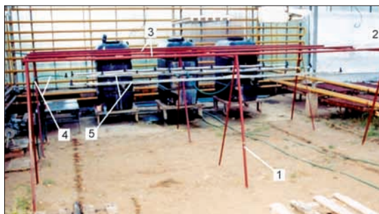
Рис. 13. Общий вид тепличного стенда для возделывания грибов-вешенок: 1 – опорные стойки; 2 – соединительные поперечные трубы; 3 – соединительные продольные трубы; 4 – соединительный шланг распределителя; 5 – система опрыскивания с распылителями
