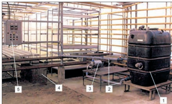
Рис. 7. Растворный узел: 1 – бак для питательного раствора; 2 – трубопроводы с запорными вентилями; 3 – самовсасывающий насос; 4 – емкость сбора рабочего раствора; 5 – шкаф управления
