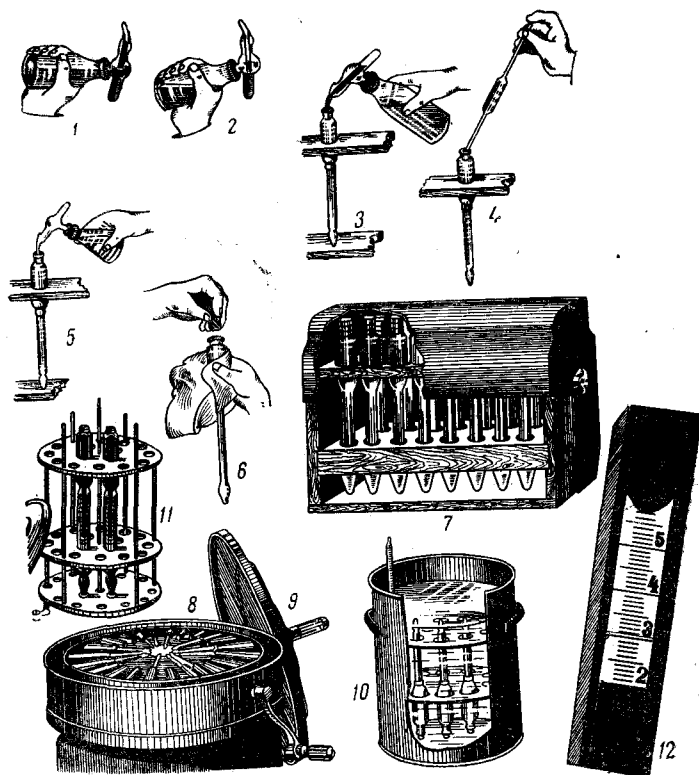
Рис. 7. Последовательность определения жира в молоке:
