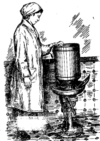
Рис. 43. Работа на фонтанном пропаривателе.
