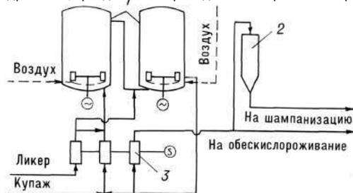
Рис. 4. Аппаратурно-технологическая схема двухстадийного культивирования дрожжей гомогенно-непрерывным способом (по Н. Г. Саривилли): 1 — дрожжевой аппарат; 2 — активатор; 3 — дозирующий агрегат
