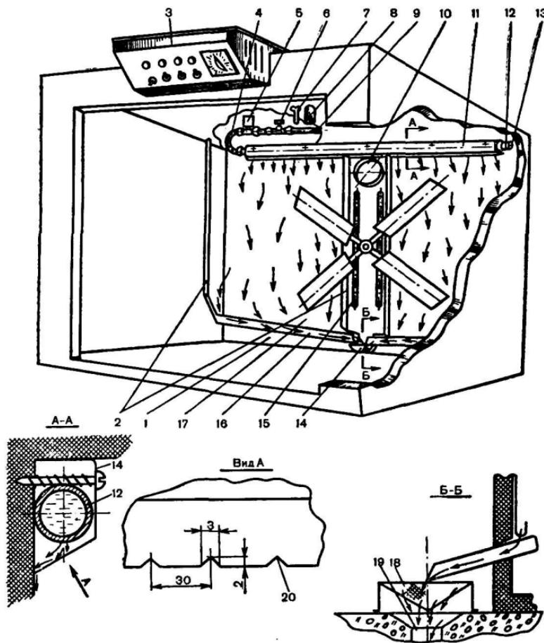
Рис. 4. Инкубатор «Универсал-55» с открытым теплообменником:
