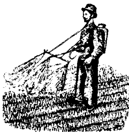
Рис. 424. Трехструйный прибор к ранцевым пульверизаторам для сплошного опрыскивания полей.
