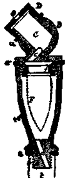
Рис. 410. Разрез наконечника „Универсаль“.
