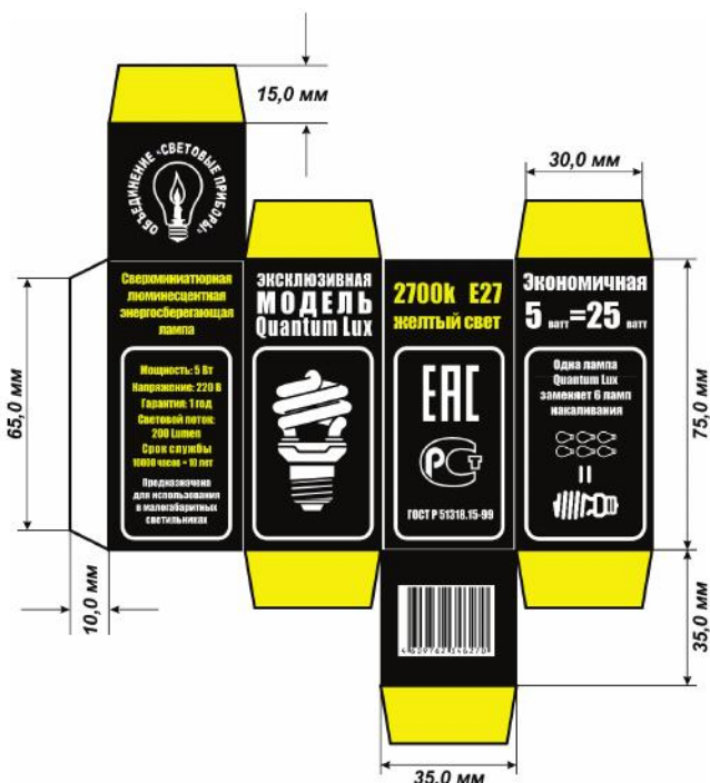
Рис. 4.10.21 ❖ Результат проектирования картонной упаковки энергосберегающей лампы
