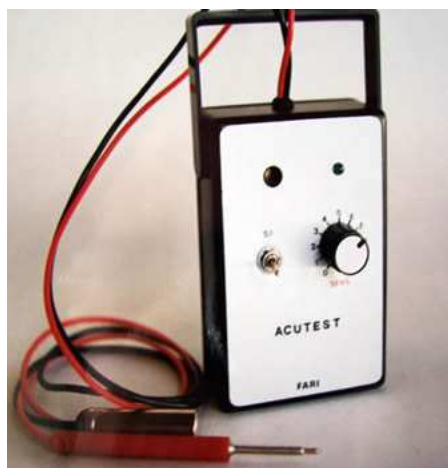
Рис. 2-5-26. Прибор для акупунктуры Acutest фирмы FARI (Аргентина).
