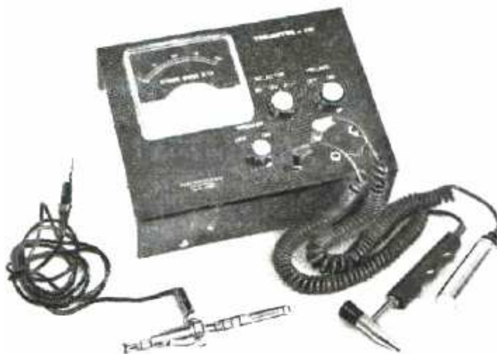
Рис. 2-3-3. Нейроизмеритель модель IW для измерения электрического сопротивления кожи.
