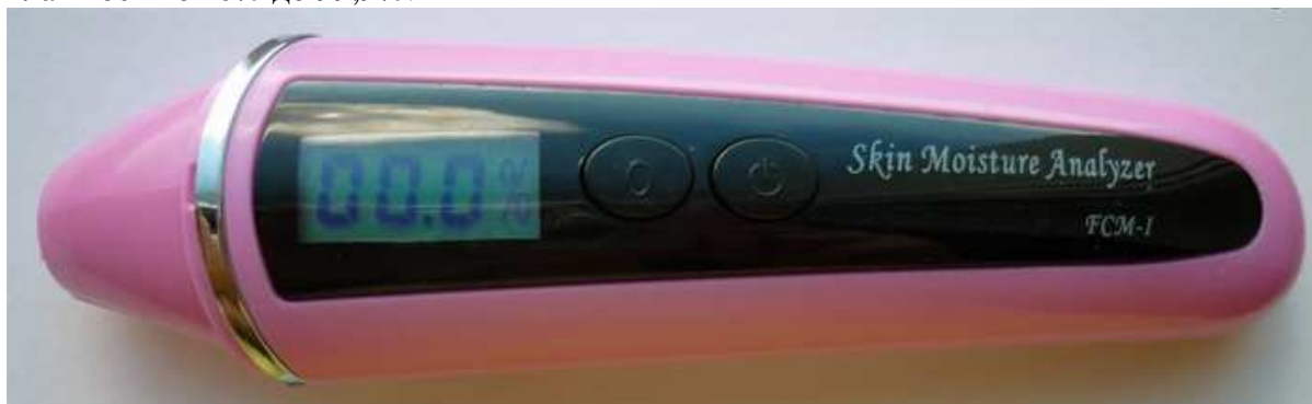
Рис. 1-5-6. Измеритель влажности Skin Moisture Analyzer FCM-1 фирмы Cheeman. (2.223 руб.). Диапазон измерения относительной влажности RH от 0% до 99,9%. Шаг измерения 0,1%, погрешность измерения 2%.
