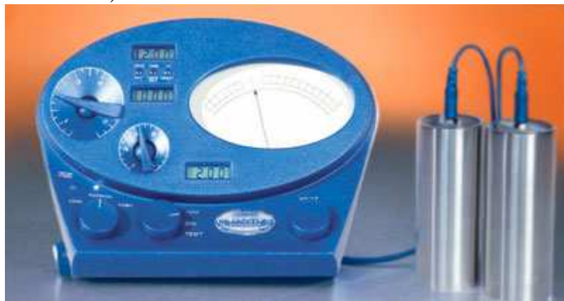
Рис. 1-3-2. Современный е-метр (e-meter) измеряющий кожно-гальваническую реакцию.
