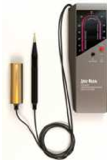
Рис. 2-5-16. Аппарат электропунктурной диагностики по методу доктора Р. Фолля «Дека-Фолль» (8990руб). Напряжение на электродах в режиме диагностики составляет 1,5В при максимальной силе тока не более 14 мкА.
