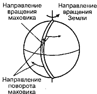
Рис. 13. Схема вращения маховика, «обернутого» вокруг Земли
