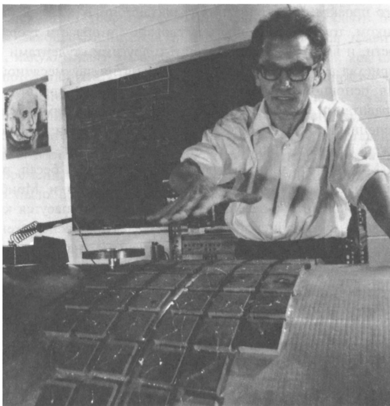
10.4. Джозеф Вебер демонстрирует пьезоэлектрические кристаллы, наклеенные около середины его алюминиевой твердотельной антенны (около 1973 г.). Гравитационные волны должны вызывать взаимные колебания концов болванки, и эти колебания должны сдавливать и растягивать кристаллы, так что они будут производить переменное напряжение, которое можно электронным образом зарегистрировать. [Фото Джеймса П. Блэра, предоставлено Национальным географическим обществом]
