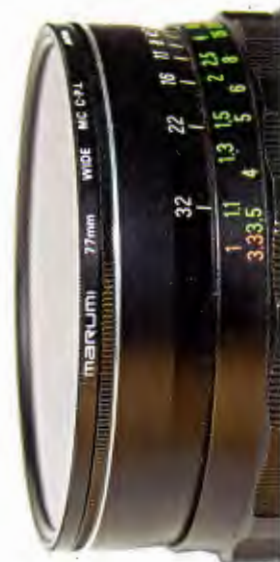
Резьбовой вариант крепления круглого фильтра.
