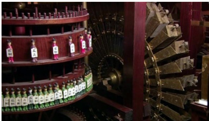
Внутреннее устройство часов Су Сонга (реконструкция)
